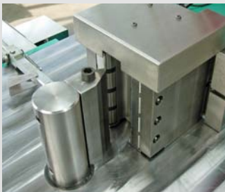
Prisma mit integriertem Messsystem für automatisches Nachbiegen.
