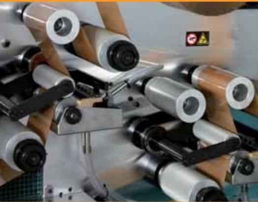
Postes pour l'application de Primer et Release avec rouleaux en aluminium trames, pour tenir en contact le ruban adhésif avec la solution chimique aussi pendant le travail de la machine à haute vitesse.
