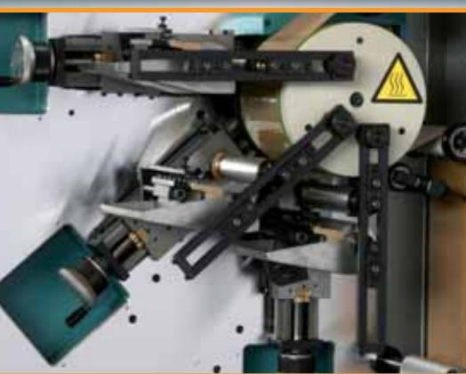
Tambour central téfloné et thermo réglé avec n. 3 postes d'impression avec double régulation facile parmi un seul système de réglage.
