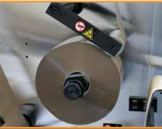
Porte rouleau de départ 3" avec frein mécanique réglable, presseur et détecteur de fin bobine.
