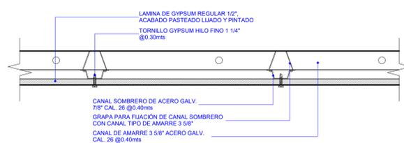
**DC-01 DETALLE DE INSTALACIÓN DE CIELO SUSPENDIDO**
